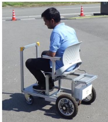
車椅子の電動アシスト機構
